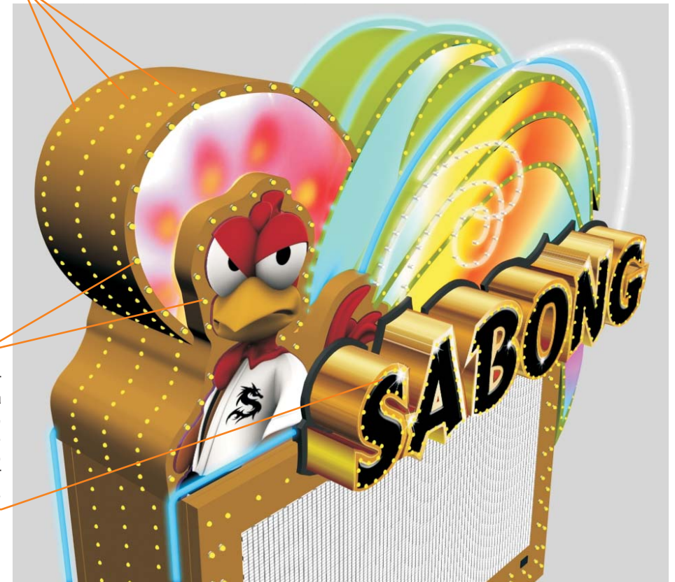
3 линии желтых светодиодов анимируются по схеме "бегущая тень" 5 каналов, синхронно, вверх
